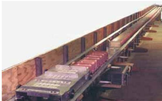
На рисунке представлено 20 метровое опытное полотно для испытания MAGLEV поездов типа Inductrack, которое содержит около 1000 прямоугольных индуктивных обмоток, каждая шириной 15 см. На переднем плане испытательная тележка и электрический
