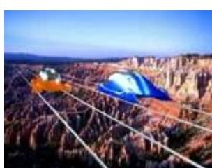
Как альтернатива этому существует чисто российская разработка, именуемая Высокоскоростным Струнным Транспортом Юницкого (СТЮ). В ее рамках предлагается использовать поднятые на опорах на высоту 5-25 метров предварительно напряженные рельсы-струны, по которым движутся четырехколесные транспортные модули. Себестоимость у СТЮ оказывается гораздо меньшей - \$600-800 тысяч за один километр, а с инфраструктурой и подвижным составом - \$900-1200 тысяч за км.
